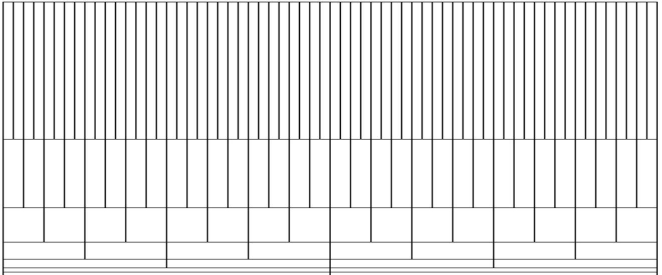
En esta figura se muestra el mosaico correspondiente a una base construida con 6 bandas o dilataciones de la wavelet, y la función de escala. Tenemos de nuevo 64 baldosas de igual área. La resolución frecuencial es de una octava: cada banda  $l$  de frecuencias va desde cierta  $f_{inf}(l)$  hasta  $f_{sup}(l) = 2f_{inf}(l)$  y abarca un ancho (“bandwidth”)  $bw(l) = f_{inf}(l)$ , la resolución temporal (y la longitud de cada baldosa) es  $long(l) = 1/2bw(l)$ , y
